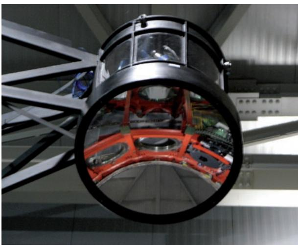
**Abb. IV.1.6:** Testmessungen mit Beschleunigungsaufnehmern, die vor kurzem an dem festen Sekundärspiegel des LBT angebracht wurden. Der Ausschnitt zeigt einen der Sensoren. Als Reflektion im Spiegel ist die Instrumentenplattform mit LUCIFER 1 ganz rechts am Derotator befestigt zu sehen.
