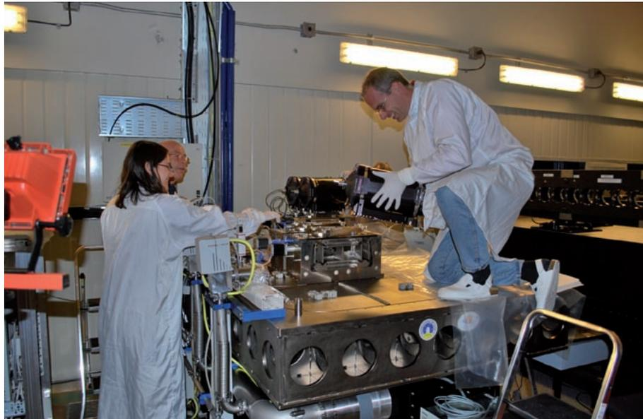
Beide Schalter werden von einem Steuerkreis angetrieben, sodass sich der optische Pfad stufenlos in einem Bereich von 120 mm (doppelte Fahrweglänge) und mit einer Genauigkeit von zwei Nanometern einstellen lässt. Zusammen mit einem internen Metrologiesystem sind die DDLs auf einer speziell angefertigten optischen Bank in nicht-kryogenen Vakuumbehältern montiert. (Abb. IV.2.1).
