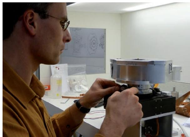
**Abb. IV.1.3:** Die Detektor-Rotationseinheit vor einem Kaltvakuumtest.
