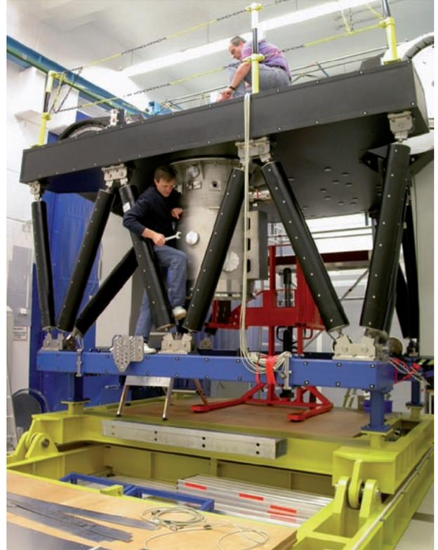
**Abb. IV.1.11:** Die obere Hälfte des Kryostaten für den Wissenschaftskanal wird für Biegungstests auf der großen optischen Bank des LINC-NIRVANA installiert.
