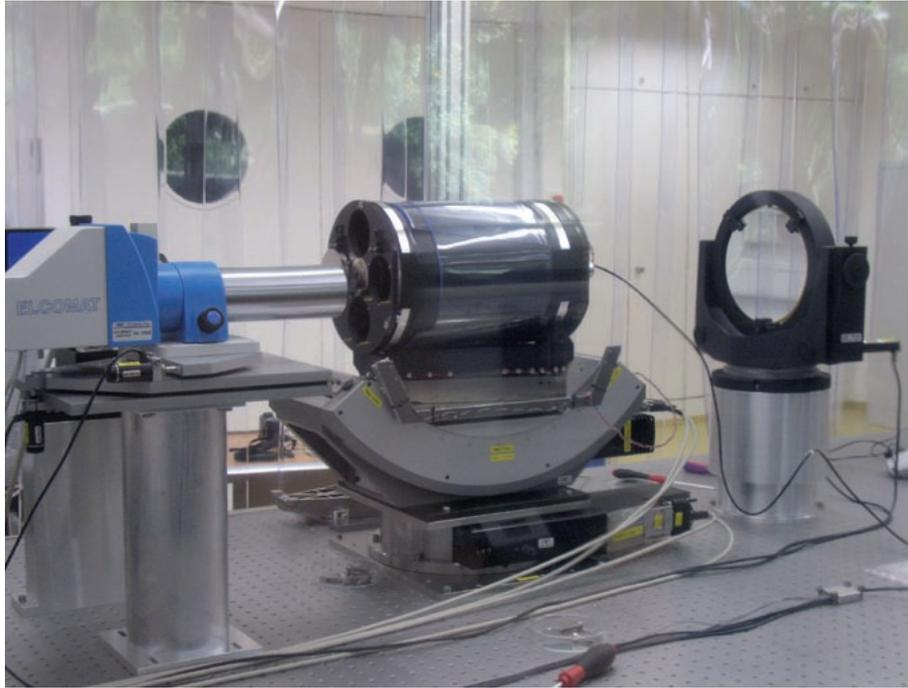
**Abb. IV.2.2:** DDL-Katzenaugen im optischen Labor des MPIA, bereit für die Wellenfrontmessungen.
