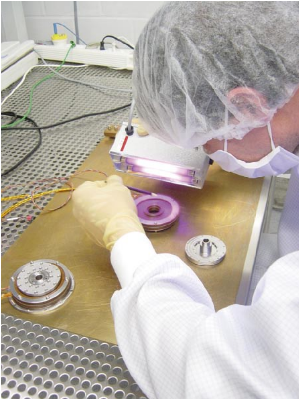
Abb. IV.9.3: Eingangsinspektion an den Kryo-Torque-Motoren im Reinraum des MPIA. Die UV-Lampe dient dem Auffinden möglicher Verschmutzungen, einer hohen Gefahr für die zentralen Lager der Filter- und Gitterräder. Alle mechanischen Teile der Motoren werden in den Werkstätten des MPIA ge-
