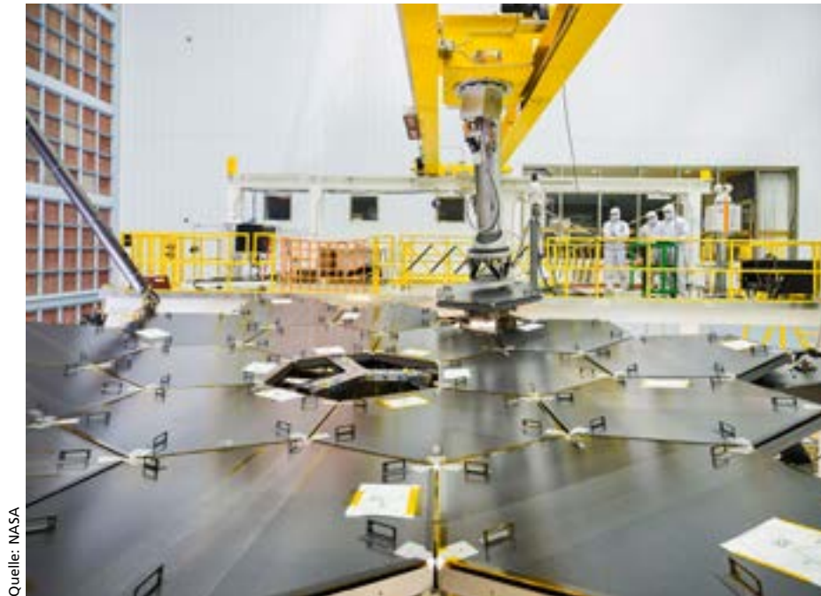
Abb. III.2.2: Nahaufnahme der Installation des achtzehnten und letzten Spiegelsegments des Hauptspiegels des James
