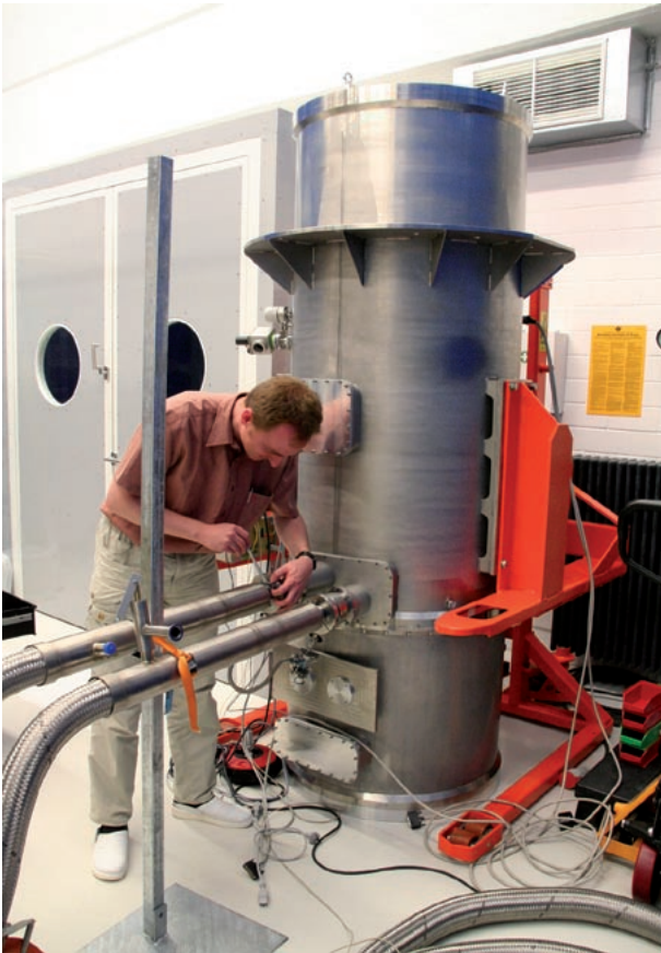
Abb. IV.5.2: Sebastian Egner, Ingenieur am MPIA, justiert die Verbindungspunkte der Vakuumkryogenleitungen am Kryostaten von LINC-NIRVANA.
