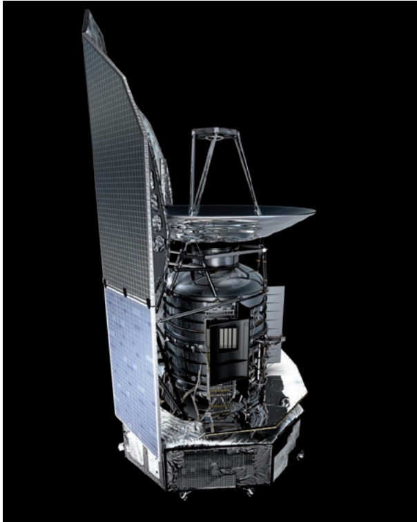
Abb. IV.11.2: HERSCHEL ist 7.5 m hoch und hat einen Querschnitt von 4\text{ m} \times 4\text{ m} . Das Startgewicht beträgt 3.3 t. Das Nutzlastmodul besteht aus dem Teleskop und dem Kryostaten. Innerhalb des Kryostaten befindet sich die optische Bank mit den Instrumententeilen, die gekühlt werden müssen. Ein Sonnenschild schützt das Teleskop und den Kryostaten vor Erwärmung durch die Sonne und verhindert, dass Streulicht von der Erde in das Teleskop eindringt; außerdem sind auf ihm Solarzellen angebracht, die den vom Raumfahrzeug benötigten Strom erzeugen.
