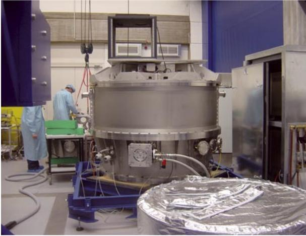
**Abb. IV.5.1:** LUCIFER I und II in der staubfreien Experimentierhalle am MPIA. Im Zentrum des Bildes steht ein vollständig zusammengebauter Kryostat für LUCIFER I während der ersten Abkühltests. Halb verdeckt dahinter und im Vordergrund Teile des zweiten Kryostaten während der Integration.
