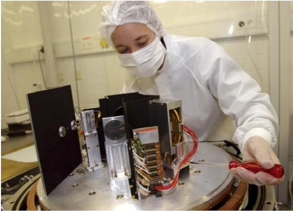
**Abb. IV.11.2:** Die Doktorandin Jutta Stegmaier bereitet den Test von Detektormodulen (wie in Abb. IV.11.1) im Flüssig-Helium-Kryostaten des MPIA vor.
