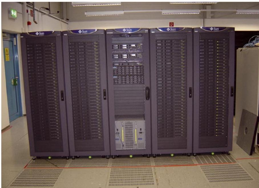
**Abb. IV.12.1:** Der PIA-Cluster des MPIA kurz nach seiner Inbetriebnahme am Rechenzentrum der Max-Planck-Gesellschaft in Garching. Der mittlere Schrank enthält unten den 144-port Infiniband switch von Mellanox und oben die beiden V40z Zugangsrechner mit den den FC-RAID-Systemen. Die vier anderen Schränke beherbergen jeweils 32 Rechnerknoten (V20z).
