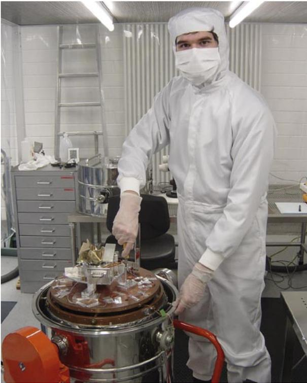
**Abb. IV.1.6:** Christian Schwab baut das MIRI-Gitterrad in den Testkryostaten für Untersuchungen bei  $-265\text{ °C}$  ein. Es müssen extreme Reinheitsanforderungen eingehalten werden.
