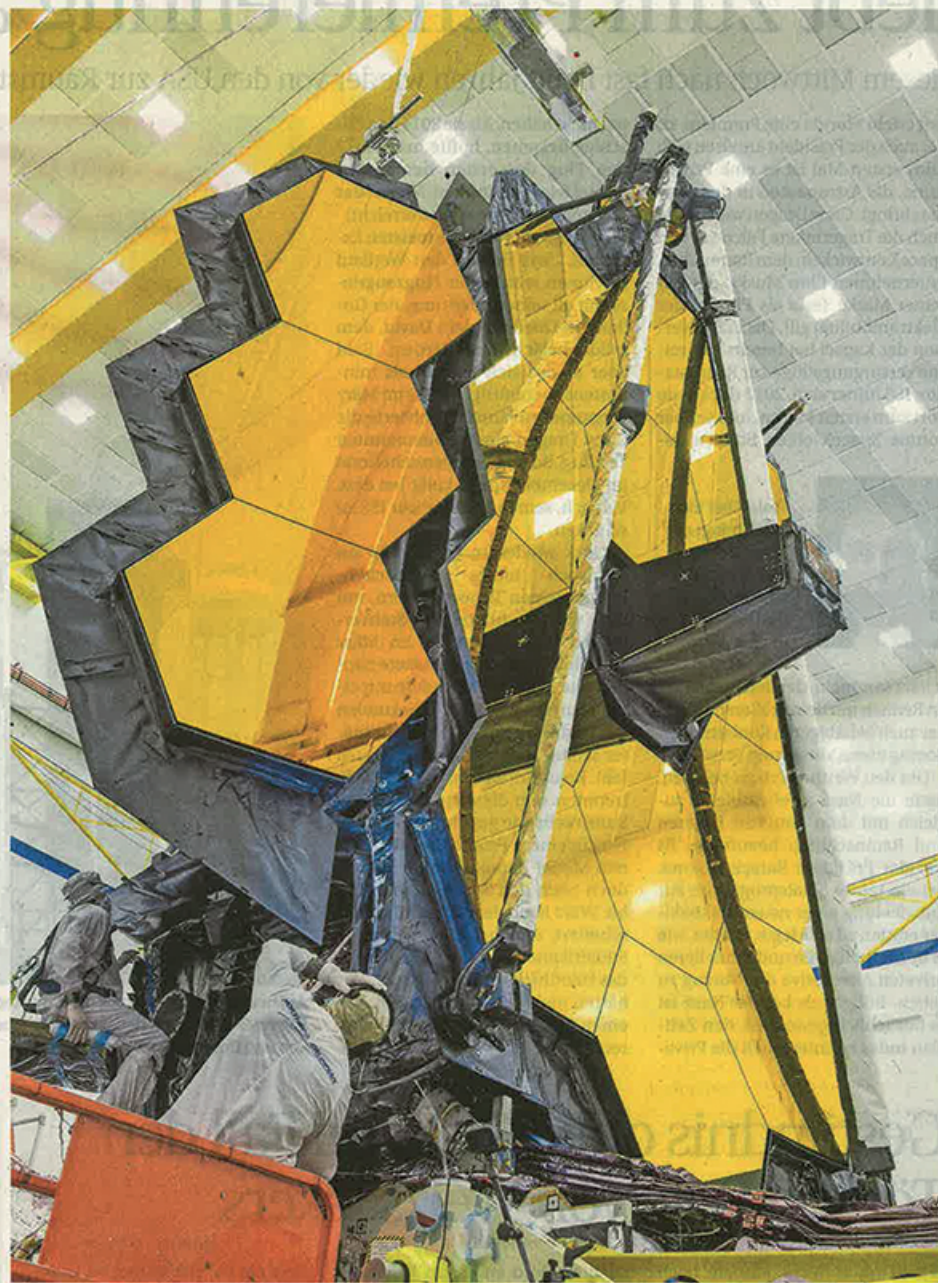
Das James-Webb-Weltraumteleskop ist der Nachfolger von Hubble. Weil sein Hauptspiegel nicht am Stück ins All gebracht werden kann, wurde er in 18 Segmente untergliedert, die sich erst in der Umlaufbahn entfalten
