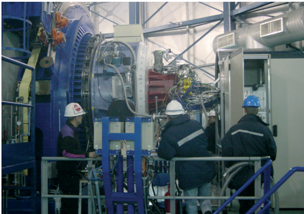
Abb. II.2: Das Heidelberger Team bei der Montage von CONICA am Nasmyth-Fokus des Teleskops YEPUN.
